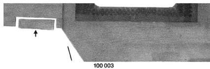
2. Teilaufgabe = Typ II: Die Auftragsnummer 100003 wurde außerhalb des grauen Unterdrucks auf die Vorderseite montiert, in die Aussparung auf der Rückseite wurde ein graues Viereck eingefügt.
