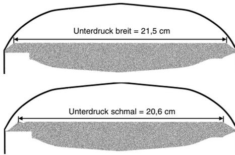
Klappentyp 1: U 1 und U 3 - Unterdruck geht nur knapp über die stark geschwungene Klappe
